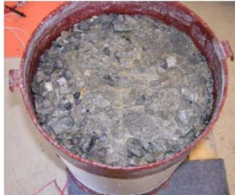
(d) Device Filled with 1 1/2" Crusher Run Gravel
