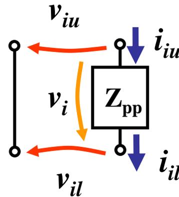
$$\begin{bmatrix} v_{iu} \\ i_{iu} \\ v_i \\ i_{il} \end{bmatrix} = \begin{bmatrix} 1 & Z_{pp} \\ 0 & 1 \end{bmatrix} \cdot \begin{bmatrix} v_{i_l} \\ i_{i_l} \end{bmatrix}$$
