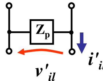
$$\begin{bmatrix} v_{i_l} \\ i_{i_l} \end{bmatrix} = \begin{bmatrix} 1 & 0 \\ 1/Z_{p_l} & 1 \end{bmatrix} \cdot \begin{bmatrix} v'_{i_l} \\ i'_{i_l} \end{bmatrix}$$
