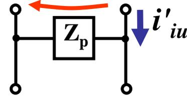
$$\begin{bmatrix} v'_{iu} \\ i'_{iu} \end{bmatrix} = \begin{bmatrix} 1 & 0 \\ 1/Z_{p_u} & 1 \end{bmatrix} \cdot \begin{bmatrix} v_{iu} \\ i_{iu} \end{bmatrix}$$
