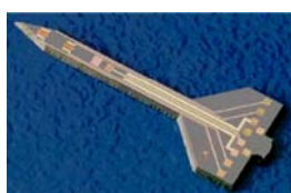
Dispositivo realizado en tecnología MEMS para el transporte de fármacos en el interior del cuerpo.
