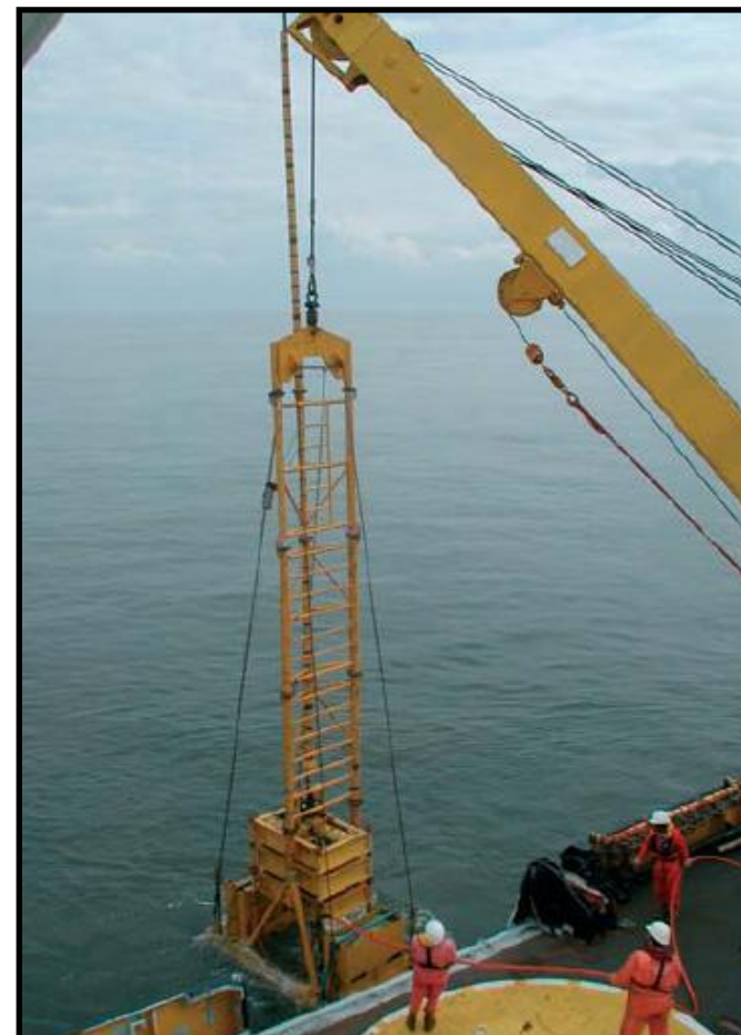
CPT (Pénétromètre statique)
