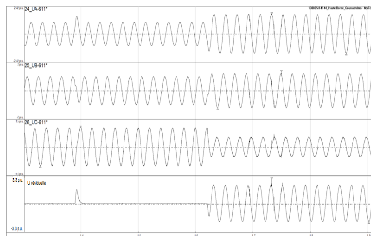
Mesure : pré-défaut suivi d'un défaut franc
