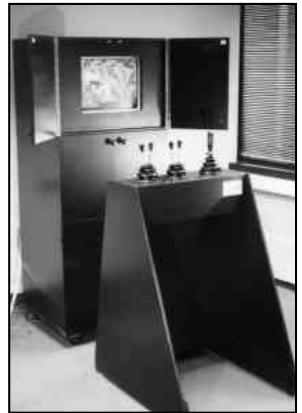
Figure 2 : le simulateur de Simlog - meuble, écran couleur et pupitre de commande.
