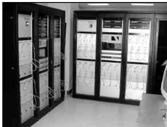
Figure 1 : Simulateur numérique en temps réel à 30 nœuds de calcul
