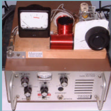
Figure 1: (Haut) Prototype de récepteur. L'antenne est couplée par induction au premier de trois circuits accordés couplés capacitivement. La sortie est prise à partir du premier stage et détectée avec une diode au germanium en mode de signal simple courant. Le cadran mesure les micro-ampères et est en série avec les écouteurs. (Bas) Le Marconi XH-100 récepteur superhétérodyne utilisé dans le re-incarnement.
