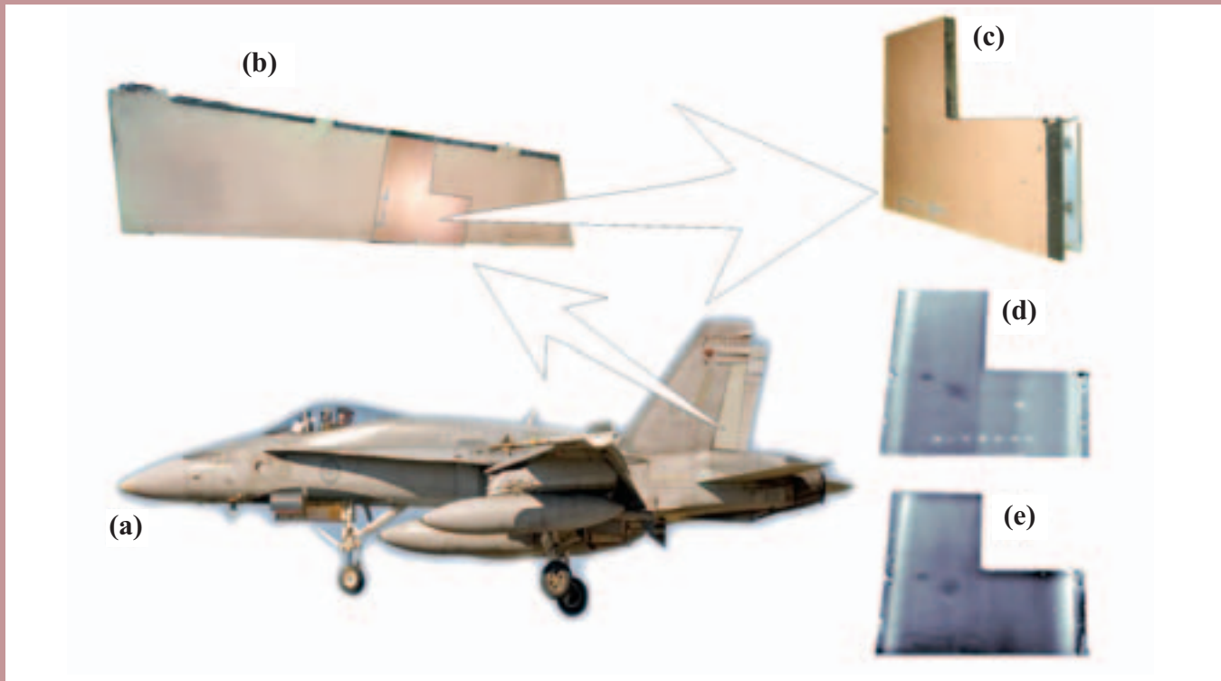
Figure 4. Rudder section inspected by optical pulsed and lock-in thermography / Section du rudder inspecté par thermographie optique: pulsée et modulée.
